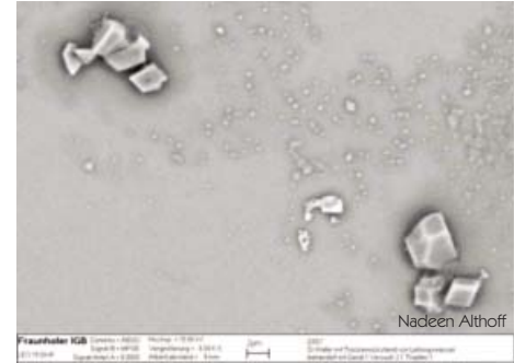
Rasterelektronenmikroskopie von Leitungswasser (Fraunhofer Institut). Im Bild links ist Wasser ohne Bormia-Behandlung abgebildet: Es zeigen sich grobe Ansammlungen der Inhaltsstoffe. Im Bild rechts ist Wasser nach Bormia-Behandlung zu sehen. Die weitgehende Vereinzelung der Inhaltsstoffe (hier Mineralien) kommt einer stofflichen Homogenisation gleich.
